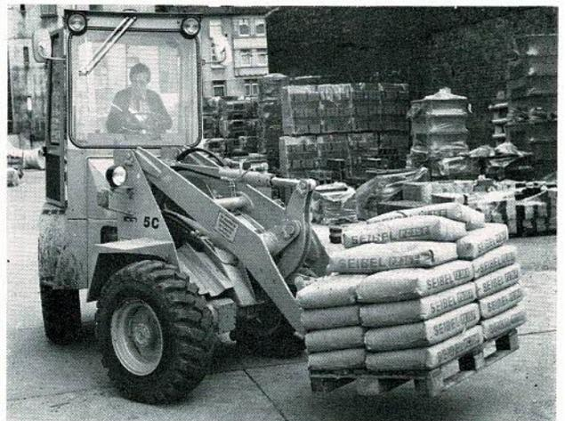
Beim Palettentransport auf dem Hofgelände kommt es auf Schnelligkeit, kleinen Wenderadius, Parallelführung des Gabelstaplers und letztlich auf Hubkraft an – der 5 C hebt Paletten bis 1200 kg Gewicht.
