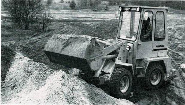
Technisch weist der 5 C die bewährten konstruktiven Merkmale der großen Hanomag-Radladerreihe auf. So die Z-Kinematik für Kraft und Tempo und die hervorragende Reichweite und Hubhöhe der Ladeeinrichtung, die das einwandfreie Beladen von Lkw leicht macht. Eine einfach funktionierende Schnellwechseleinrichtung und eine exakte Parallelführung der Ladeschwinge für Arbeiten mit dem Gabelstapler sind selbstverständlich – mit diesem Lader kann jeder umgehen.
