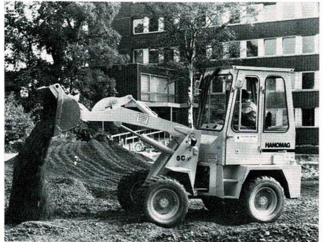
Typische Arbeit rund um Neubauten: die Anlage der Grünflächen, Verteilen und Abziehen des aufgeschütteten Materials. Geländegängigkeit, große Bodenfähigkeit und die Wahl der richtigen Bereifung sind hier wichtig.
